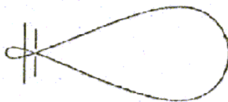
شکل (۳-۱۳) نمونه پرتو تشعشع برای آنتن نیم موج (دوقطبی) با رفلکتور
